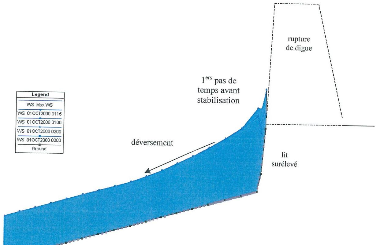
Figure 12 : Représentation schématique de la variation de la ligne d'eau lors d'une rupture de digue (copie écran d'une simulation réalisée)
